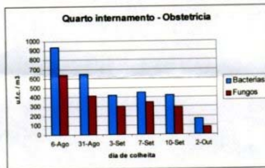
FIGURA 1. - Efeito do aparelho esterilizador de ar fabricado sob licença da patente americana 5874050 na manutenção do nível de bactérias e fungos existentes no ar do quarto de internamento com as camas 7, 8, 9 e 10 (Obstetria). O primeiro aparelho foi ligado no dia 6 de Agosto, e o segundo no dia 10 de Setembro, ambos depois de terem sido recolhidas as amostras desse dia.
